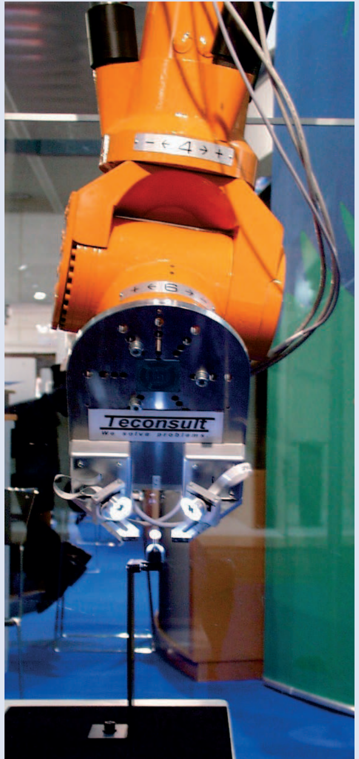
ROSY beim Vermessen mit Kameras und Kalibrierkugel
